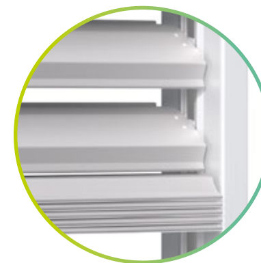
6 Posición de trabajo AST standard. La persiana baja con una inclinación de 45 o 70 grados. Con la posición de trabajo AST, se evita la fase de oscurecimiento de la habitación mientras baja la persiana.
