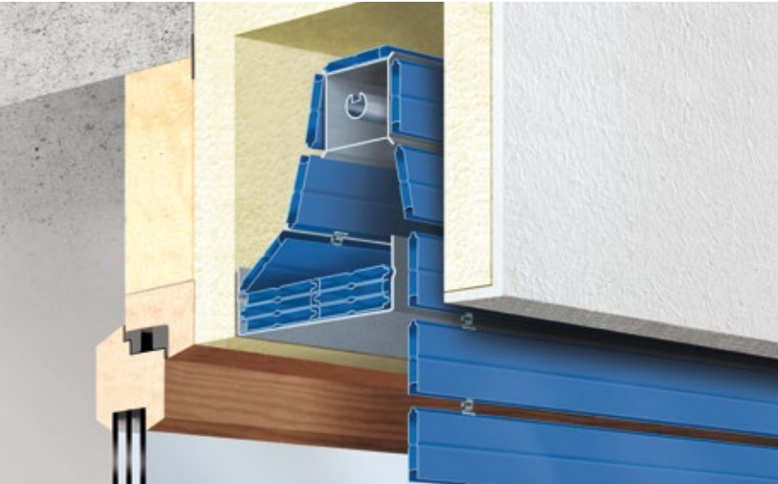
Sección horizontal del accionamiento por manivela articulada
