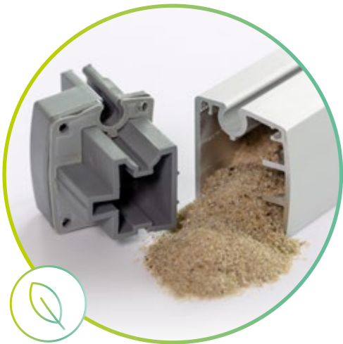
4 Arena en el zócalo. En Griesser hemos descartado el empleo habitual del acero para dar peso a la pieza, y en su lugar hemos utilizado arena como material de relleno respetuoso con el medioambiente.
